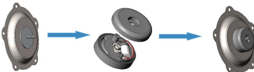
Вкрутить болт в датчик (усилие затяжки 1 Н\*м)
