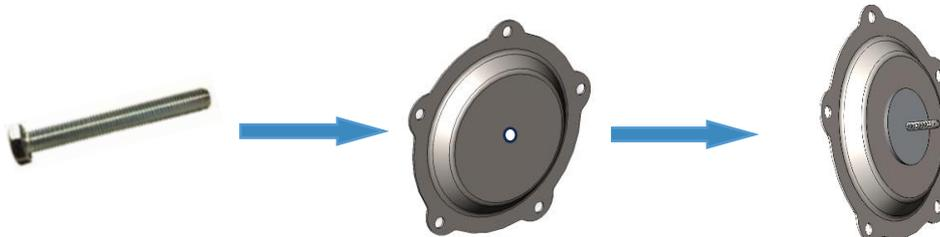
Выкрутить установочный болт и вставить его с внутренней стороны крышки ступицы
