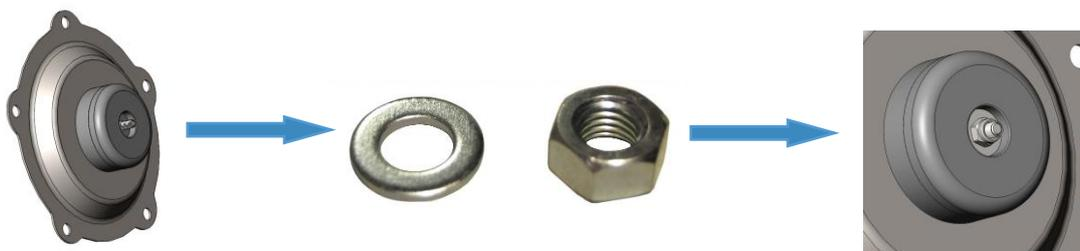
Установить шайбу с резьбовой стороны болта и закрутить контргайку
